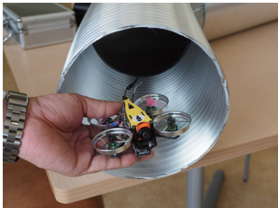
超小型ドローンによる配管内点検
