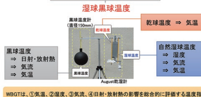
図1 WBGT（湿球黒球温度）の測定方法
