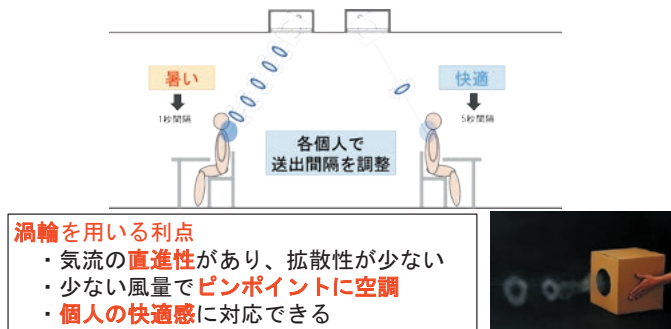
図7 渦輪を用いたパーソナル空調
