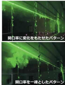
写真2 気流可視化試験
