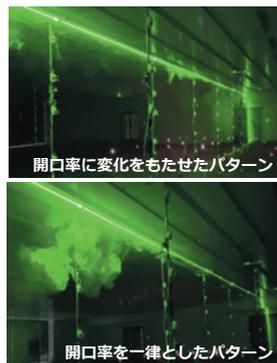
写真2 気流可視化試験
