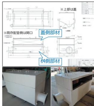
図1 製作図と製作状況写真
