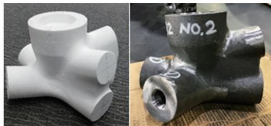
写真2 鑄鋼(左:発泡スチロール模型、右:実物)
