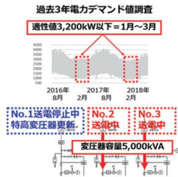
図1 1回線送電停止検討図
