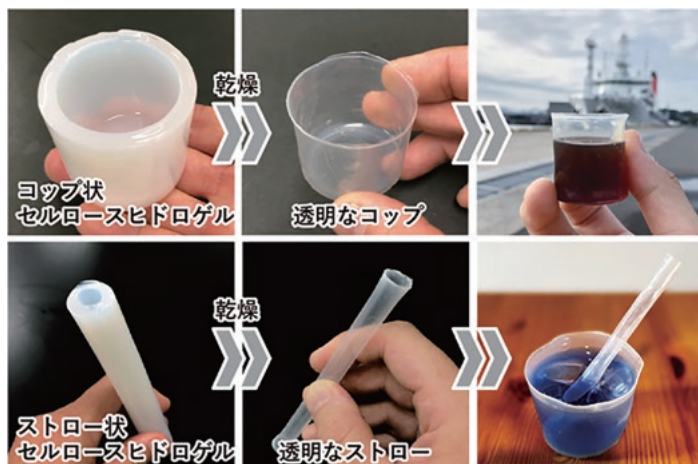
図3 コップやストローなどの立体的な形状に成形した透明な板紙。
