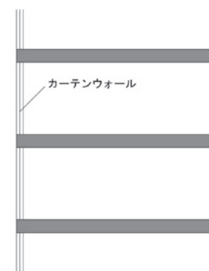
以前のカーテンウォール形式 （床スラブの上下で固定）
