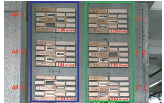
ランク別(破損の程度)に引張試験を実施。再利用可能と判断
