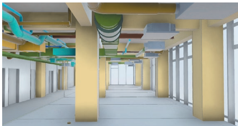
BIMモデルによる納まり検討
