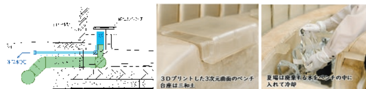
図10 「廃氷」とクールチューブによる冷却の仕組み
