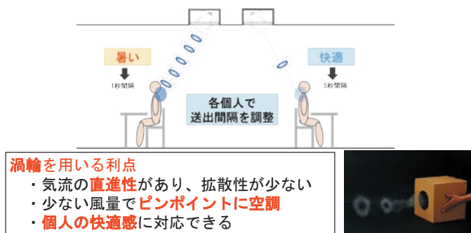
図7 渦輪を用いたパーソナル空調
