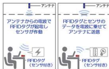
図1 RFIDシステムの仕組み
