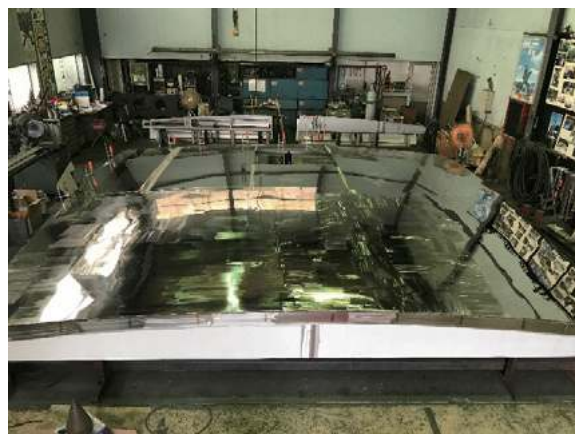
溶接後全面を職人の技術で鏡面に加工 設計：株式会社竹中工務店、長谷川 寛、上河内 浩
