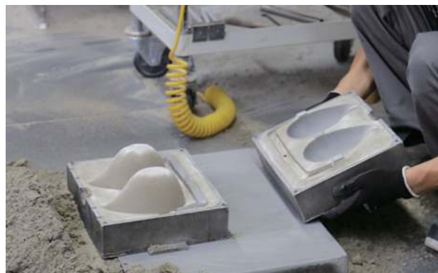
砂で鋳型を作る工程
