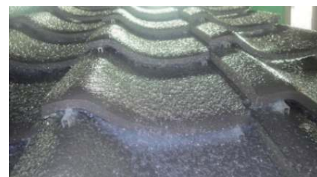
写真7 高粘度液体が瓦隙間に留まる様子
