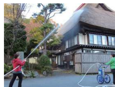
写真3 茅葺き屋根の広範な散水範囲
