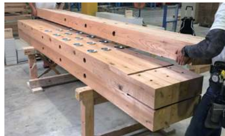
写真2 複合圧縮材（束ね柱）の製作風景
