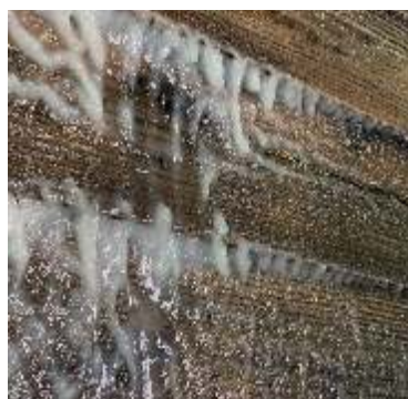
写真5 高粘度液体が板壁に付着した様子
