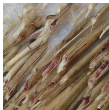
写真6 高粘度液体が茅材に留まる様子
