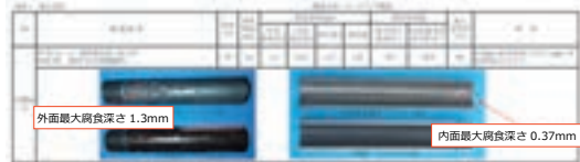
図2 冷水配管劣化状況報告書
