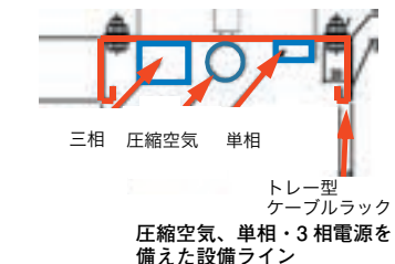
三相 圧縮空気 単相 トレー型ケーブルラック 圧縮空気、単相・3相電源を備えた設備ライン
