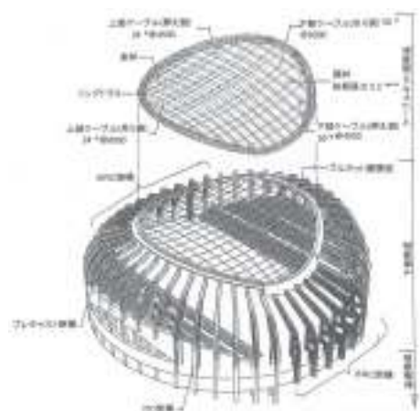
図2 構造システム図
