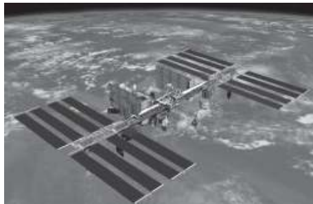
図1 ISSの太陽電池パドル ©JAXA/NASA
