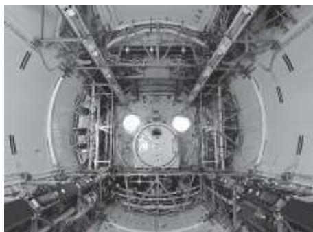
図7 「きぼう」 構造壁 (二次構造は一部機装済み)
