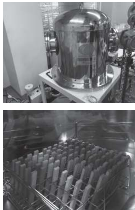
図3 真空チャンバ（上）及び真空チャンバ内の実験試験体（下）
