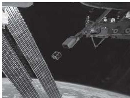
図3 「きぼう」から軌道投入される小型衛星
