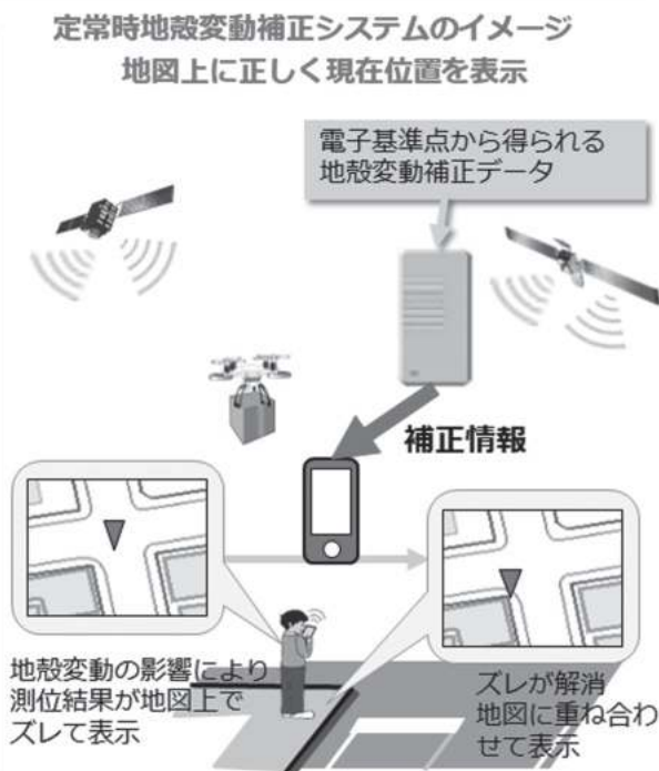
図-7 地殻変動を補正する仕組み
