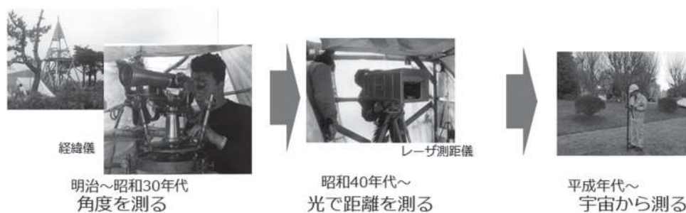
図－1 測量技術の変遷
