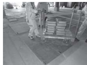
写真3 台車走行試験状況
