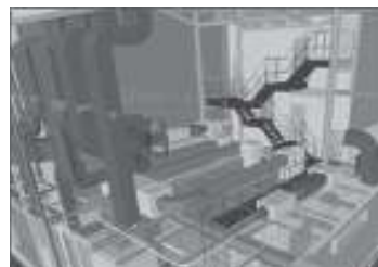
図1 BIMモデルによる配管ルート調整
