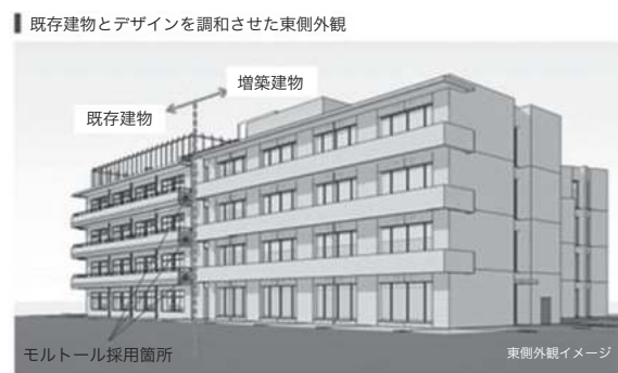
図2 モルトール適用箇所
