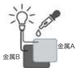
図1 異種金属による一次電池の発電
