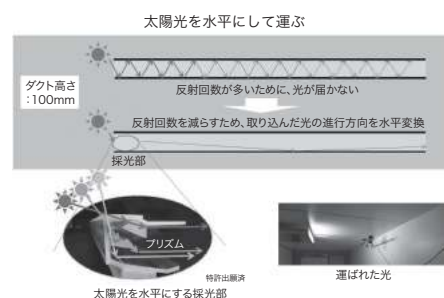
図3 T-Light™ Duct 100のシステムのイメージ
