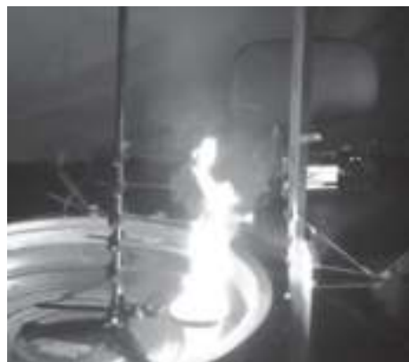
図2 水面での油火災実験
