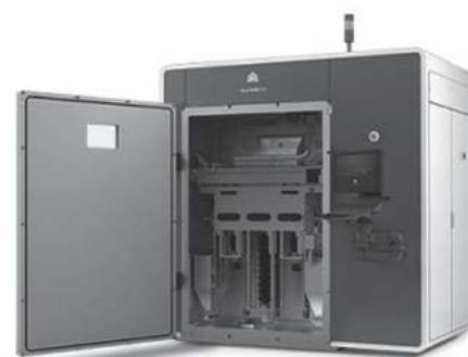
写真1 金属3Dプリンター装置の外観 (3DSystemss社 ProX320)
