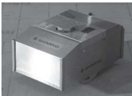
写真1 施工図描画ロボット
