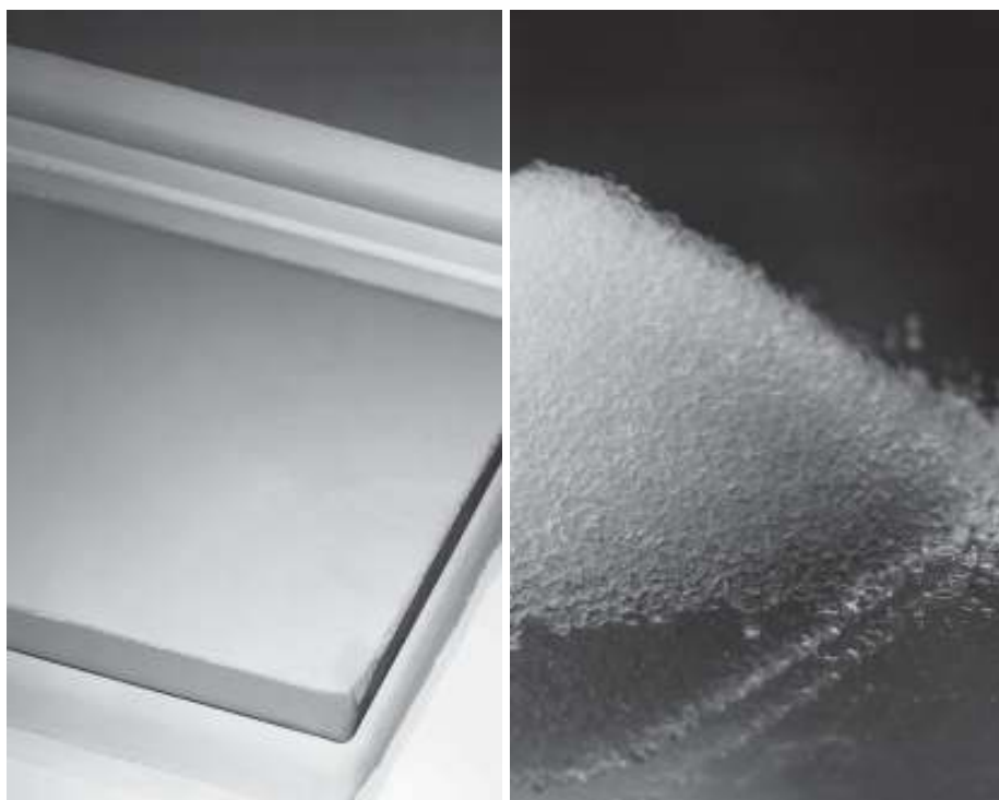
図2 ティエムファクトリ社によるモノリスタイプ（左）およびパウダータイプ（右）のPMSQエアロゲル製品SUFA
