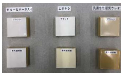
写真1 耐候性試験前後の写真
