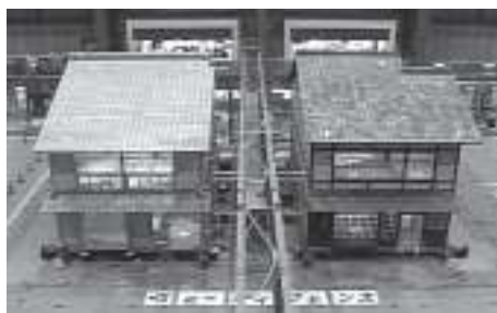
京町家の実大振動台実験 左：新築京町家、右：移築京町家
