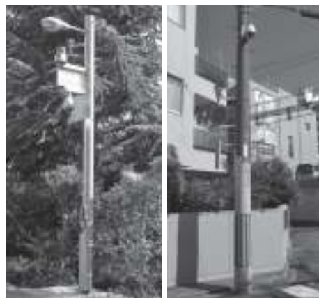
（左）2002年に大阪府下で二番目に設置された豊中市新千里東町の街頭緊急通報システム（通称「スーパー防犯灯」）。通報ボタンを押すとカメラが作動し、警察署に映像が送られる等の機能が備わっている
