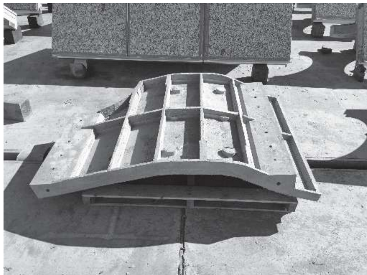
写真2 超軽量のGRCキャスト製法使用例
