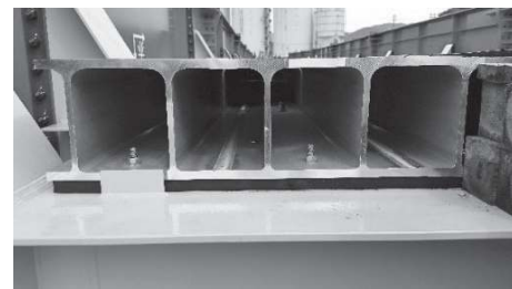
写真3 「緊急仮設橋床版」当協会撮影（床版は200mm×160mmのアルミ押出材を連結）
