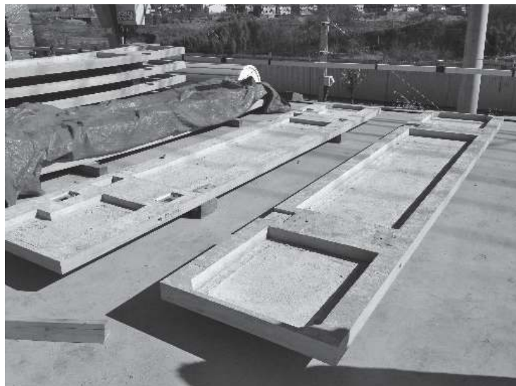
写真1 一般的なGRCの製品裏面例
