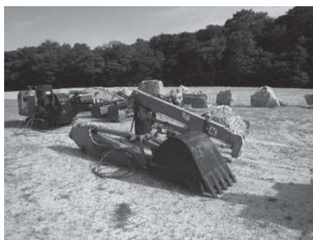
写真3 分解された重機の輸送パーツ
