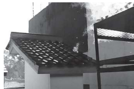
写真1 火の粉による出火実験の様子
