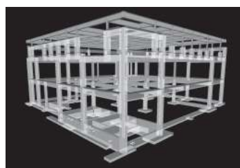
図2 BIMを用いた躯体3Dモデル
