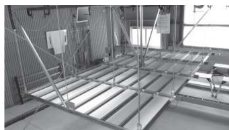
耐震試験（社内試験）状況
