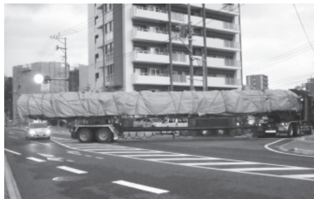
写真4 先導車付きポルトトレーラーで運搬
