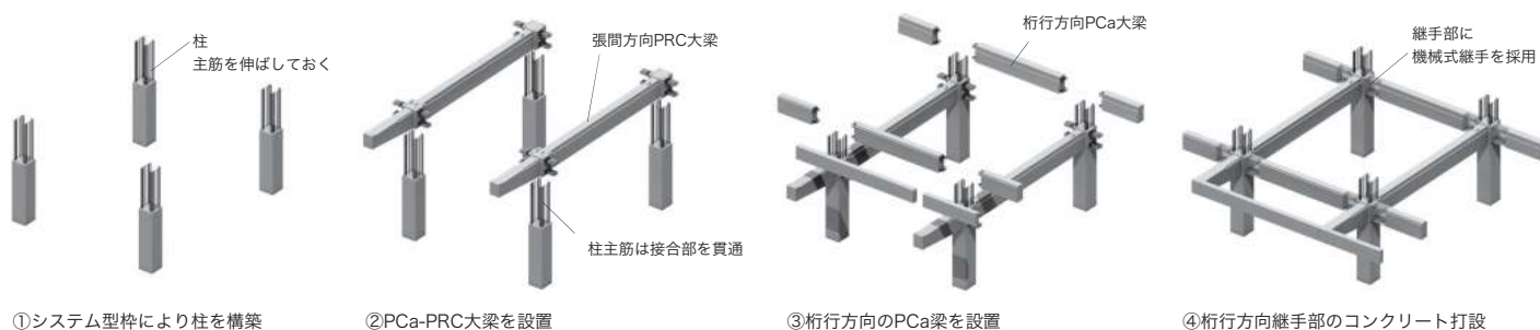
コンコースの構造体構築手順
