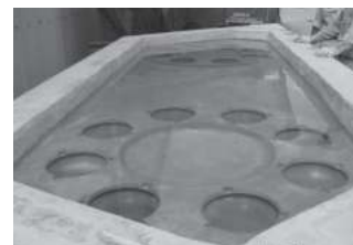
GRCパネル裏面の水張試験
