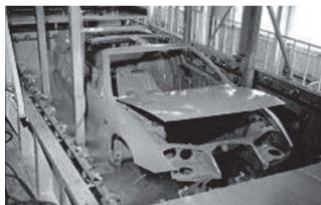
写真2 自動車ボディーの電着塗装
