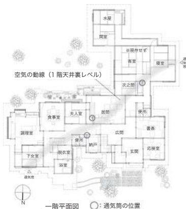
図2 八木邸1階には3箇所に通気筒がある
