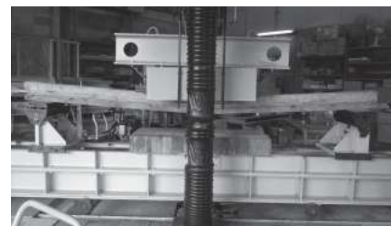
写真2 既存木材の材料試験状況
