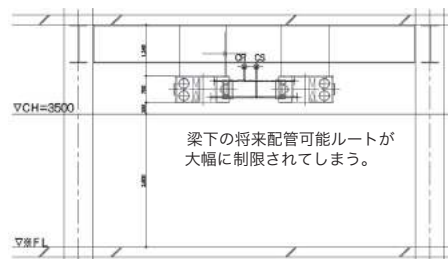
図1 FCFUと冷水主管の一般的な高さ関係
