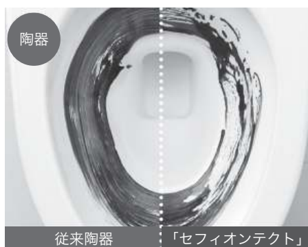
図5 セフィオンテクトの効果 ※10年使用後相当の便器にて比較。便器内に当社で合成した擬似汚れを塗布。
