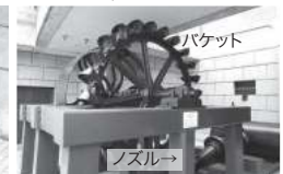
水の衝撃で回るベルトン水車 発電機
