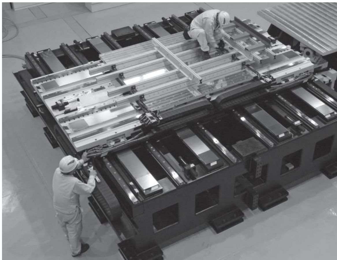
最大2tまでの検査物を 載せることができる 振動台 2号機が新たに加わった
