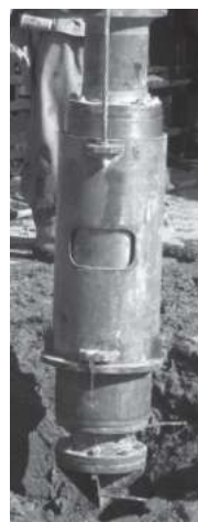
写真2 ロケット型採取器
