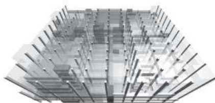
図6 構造設計データによるBIMモデル
