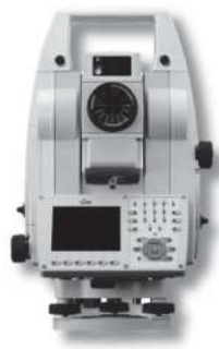
図2 ひび割れ計測システム「KUMONOS」
