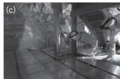
図4 (c) 原子核乾板設置の様子。写真手前に敷き詰められているアルミ板の中に原子核乾板を挟み込んで固定している。
