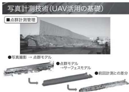
図1 SfM技術を使った変位計測
