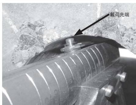
写真5 孔内局部載荷法
