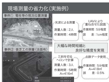
図4 2DCADとオルソ画像から机上測量を実施
