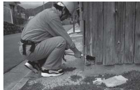
図4 ピロディンによる腐朽被害調査（鳥取県西部地震被害住宅の腐朽土台を測定）
