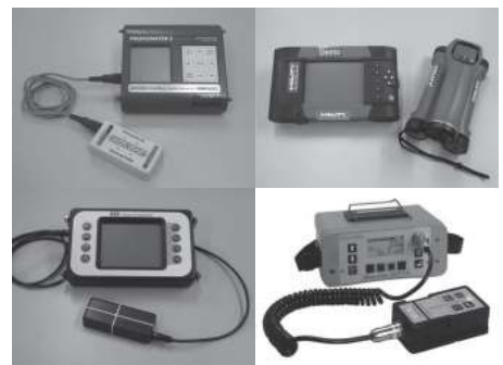
図2 電磁誘導法による鉄筋探査機の例
