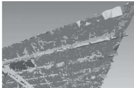
図2 折版面を15m下からスキャンし変換を試みた例
