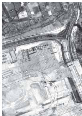
図3 2DCADとオルソ画像の重ね合わせ事例
