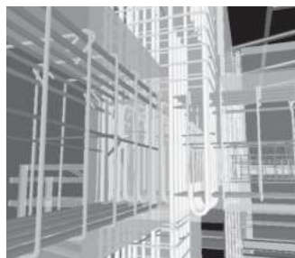
図1 2D配筋納まり図と3Dモデル
