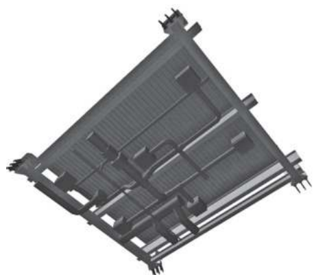
BIM 配管とデッキプレート
