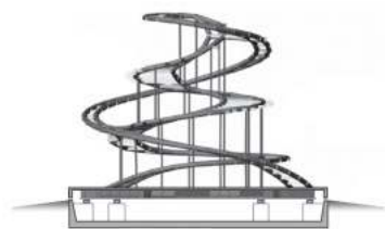
図2 基礎免震を採用する
