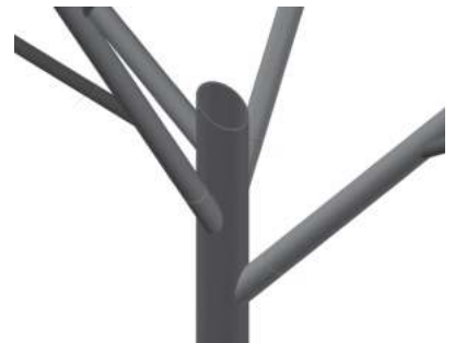
図4 樹木柱分岐部の詳細
