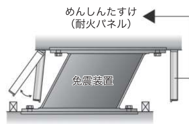
免震装置変形時のイメージ（開閉式の場合）
