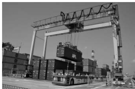
写真5 自動搬送台車（AGV）及びRTGによる荷役風景
