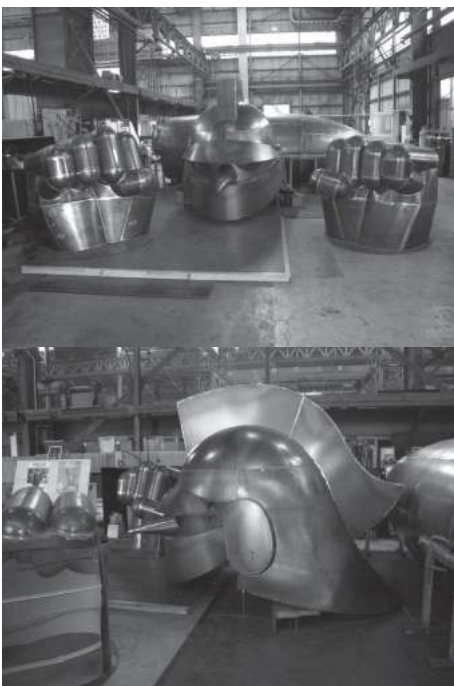
写真7. 8 工場パーツ製作風景。頭と顔、手の部分がほぼできあがっている
