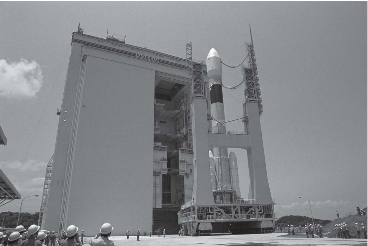
写真3 VABで組み立てられたH-II AロケットがMLで移送されている様子。スライドドアが大きく開いている（写真提供：JAXA）
