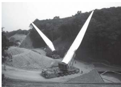
写真2 山間のブレード輸送
