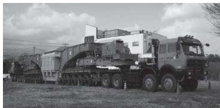
写真3 240型変圧器専用特殊トレーラ
