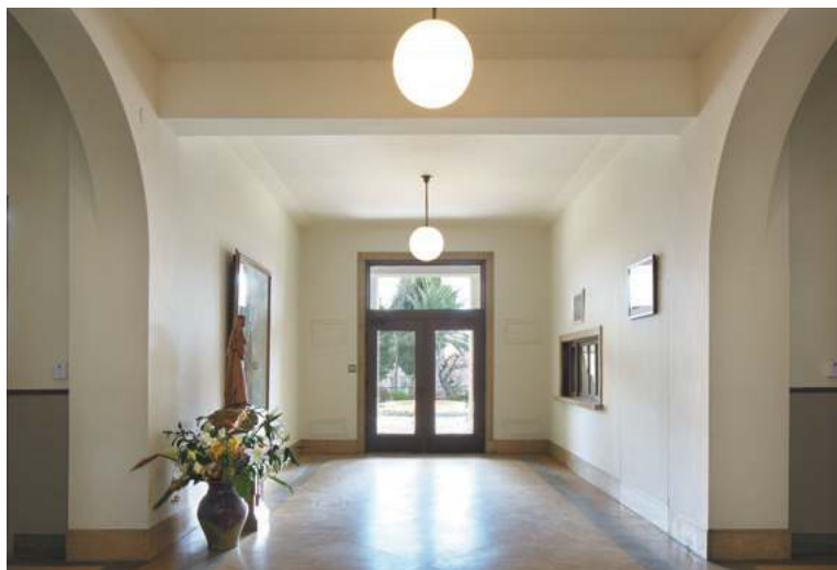
中高棟ロビー：照明器具は、意匠はそのままに、白熱灯からLEDに交換
