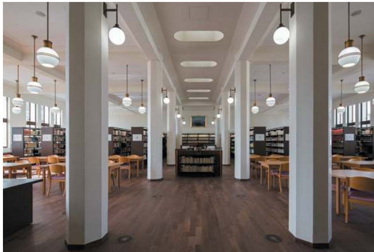
図書館棟 図書室：トブライトからの自然光と、既存校舎の器具の意匠を引用したグローブ照明による柔らかな照明計画。
