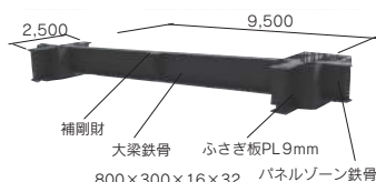
【図-2】 鉄骨工場ジョイント詳細
